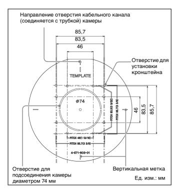
После выбора направления, в котором камера будет выполнять съемку, сделайте отверстие надлежащего размера (диаметром 74 мм) для подключения кабелей с помощью прилагаемого шаблона. Затем отметьте положение четырех монтажных отверстий для установки кронштейна. Метка "↑" означает направление отверстия кабельного канала (соединяется с трубкой) камеры.
