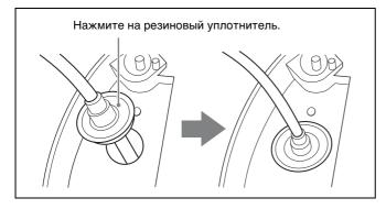
Прикрепите кабель LAN с помощью резинового уплотнителя к отверстию камеры с меткой  $\triangle$ .
