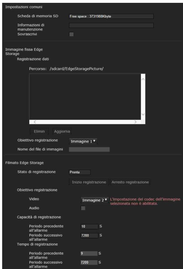
La funzione Edge Storage permette di registrare segnali audio o video a partire dai risultati della rilevazione degli allarmi, ad esempio in caso di blocco della rete, dopodiché le immagini e i suoni registrati possono essere trasmessi in streaming con lo stesso protocollo in tempo reale.
