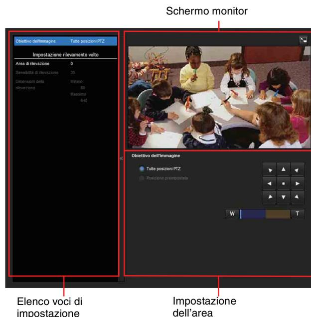
La funzione di Rilevamento volto reagisce ai volti che appaiono nell'immagine trasmessa dalla telecamera e attiva l'allarme.
