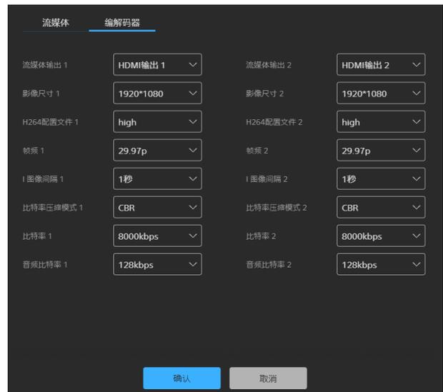
[ 流媒体输出 1 ]、[ 流媒体输出 2 ]：选择流媒体输出的内容 ([ HDMI 输出 1 ] 或 [ HDMI 输出 2 ])。
