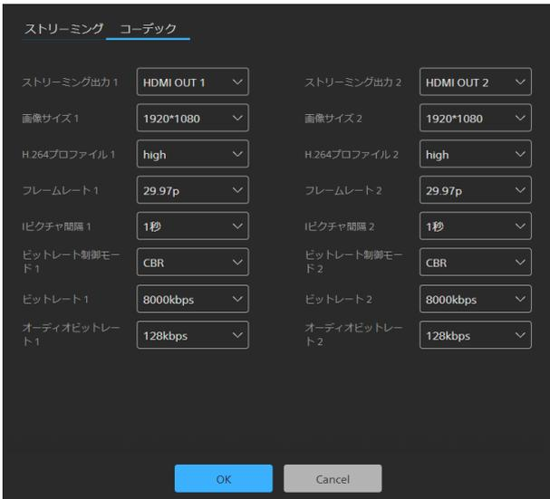
**[ストリーミング出力1]、[ストリーミング出力2]：**ストリーミング出力する内容を [HDMI OUT 1] または [HDMI OUT 2] から選択します。
