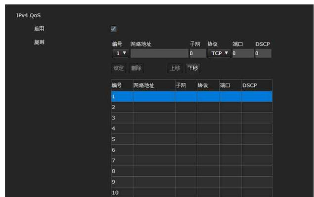
使用此菜单可对发送自设备的数据流量包做标记，并配置 QoS 控制的设置。可使用 IPv4 地址、端口号、协议等创建数据流量类型的规则。可最多注册 10 条规则。
