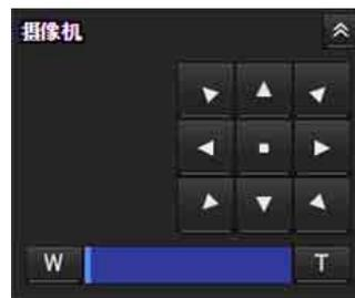
通过使用控制面板，可以对当前显示的监视器图像操作摄像机的摇摄 / 倾斜、移动到中心位置、变焦和对焦。
