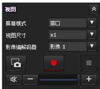
可以更改屏幕模式、图像的视图尺寸和图像编解码器。可以存储静止图像和视频（也可以停止存储视频），还可以调节音频输出音量。
