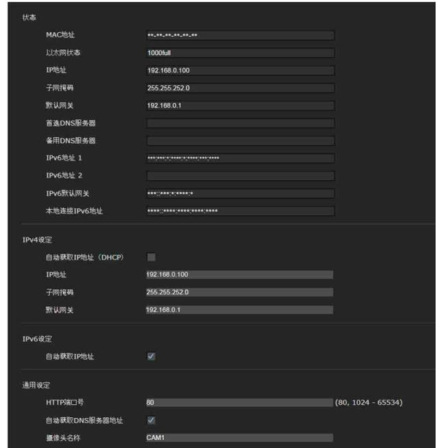
本节介绍通过网络电缆连接摄像机的菜单。
